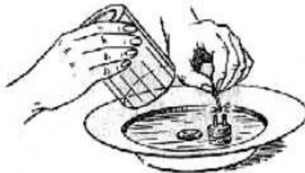
Fig. 70. Procedimiento para recoger debajo de un vaso invertido todo el agua que hay en un plato
